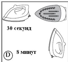
Функция автоматического выключения утюга действует следующим образом: Оставленный на подошве или опрокинутый на бок утюг, который нагрелся до определенной температуры, но не эксплуатируется, автоматически отключится через 30 секунд. Если утюг не эксплуатируется и находится на пяте-опоре в вертикальном положении - режим автоматического отключения сработает через 8 минут (рис. D). Автоматическое отключение утюга сопровождается звуковым сигналом.
