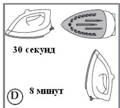
Үтікті автоматты сөндіру функциясы келесідей тәсілмен жүзеге асады: Белгілі бір температураға дейін қыздырылған, бірақ, қолданылмаған үтік, сондай-ақ, табанында жатқан немесе бір қырынан жатқан үтік 30 секундтан кейін автоматты түрде сөнеді. Егер үтік пайдаланылмаса және таяныштіректі тігінен тұрса, - автоматты түрде сөну режимі 8 минуттан кейін қосылады ( D сурет). Үтік автоматты түрде өшкен кезде дыбыстық сигнал естіледі.
